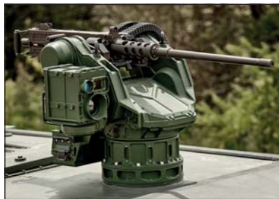
Detailní pohled na zbraňovou stanici MANTIS s lafetovaným 12,7mm kulometem
