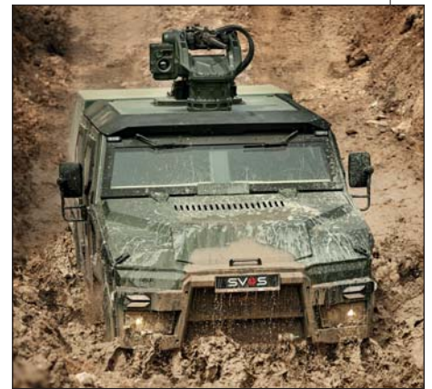
MANTIS s kulometem ráže 12,7mm na vozidle MARS DC 4x4
